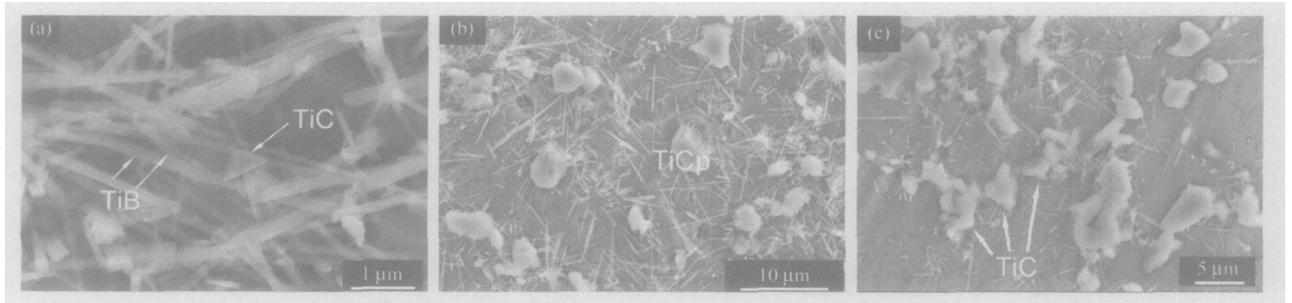
图 4 复合材料的 SEM 照片. (a)  $W_4P_1$ ; (b)  $W_1P_1$ ; (c)  $W_1P_4$
