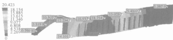
图 12 车架位移变形分布仰视图
