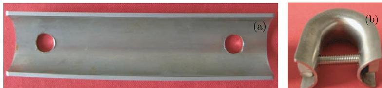
图 1 690 合金试样外观形貌. (a) 弯曲前; (b) 弯曲后
