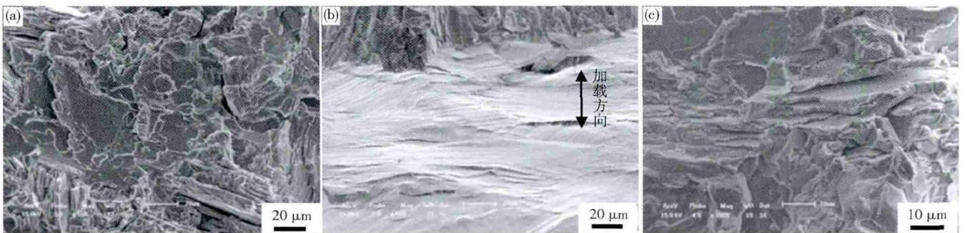
图 8 合金在 750 °C 拉伸后的断口形貌. (a) 解理台阶; (b) 片层团转动; (c) 片层张开
