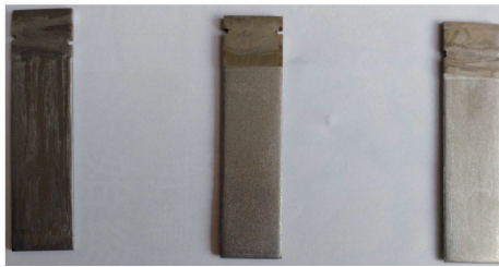
图 7 电解法萃取抑制剂时不同热轧板及不同位置的表面低倍形貌(左:缺陷热轧板边部;中:缺陷热轧板边部;右:正常热轧板边部)
